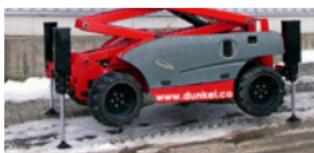
Per Stützen lassen sich die Diesel-Bühnen in Waage bringen.
