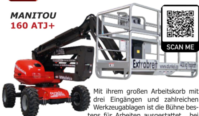
Mit ihrem großen Arbeitskorb mit drei Eingängen und zahlreichen Werkzeugablagen ist die Bühne bestens für Arbeiten ausgestattet, bei denen mehrere Personen erforderlich sind. Durch die große Bodenfreiheit in Kombination mit 4 lenkbaren Antriebsrädern lassen sich Hindernisse leicht überqueren und Arbeiten im Freien auf unebenen und schwierigen Böden durchführen.
