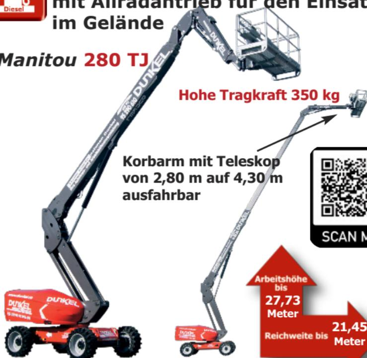
Die 280 TJ hat einen 2,30 m breiten Arbeitskorb mit hoher Tragfähigkeit. Bei eingefahrenem Korbarm 350 kg und bei ausgefahrenem Korbarm 240 kg Traglast. 2-Rad-, Allrad- und Hundeganlenkung. **47 PS Dieselantrieb, low emission.**
